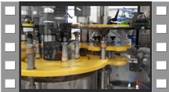
Le bottiglie senza fili sono realizzate su misura a partire dai disegni delle Sue bottiglie. Integriamo un sensore di coppia ad estensimetri con una scheda di misura Bluetooth Andilog all'interno della bottiglia. A seconda della coppia da applicare, dei vincoli di produzione e delle dimensioni, produciamo le bottiglie in plastica in stampa 3D o in acciaio inox o alluminio.
