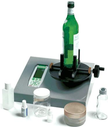
I torsiometri Anditork sono stati sviluppati per l'apertura manuale e la misurazione della coppia di avvitamento sulle bottiglie. Sono adatti ad una grande varietà di campioni come bottiglie (acqua, sciroppo, vino e liquore), fiaschi (profumo, medicale), provette, barattoli o vasi per esempio.
