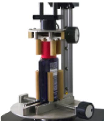
Le impugnature e le piastre permettono di testare diversi diametri, forme e dimensioni delle bottiglie.
