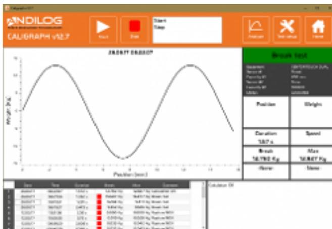
Con il software di acquisizione e analisi Caligraph, è possibile seguire in tempo reale l'evoluzione della curva di forza e coppia, salvare i propri dati, calcolare automaticamente i risultati e modificare report di prova personalizzabili.
