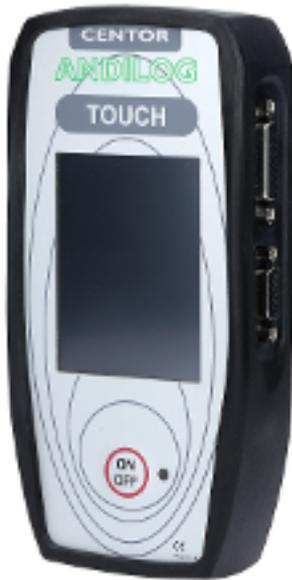
Il Centor Star Touch dotato di modulo Bluetooth consente di visualizzare in tempo reale e senza fili i valori di coppia misurati. Ha funzioni specifiche come la misurazione del massimo o la tracciatura della curva direttamente sullo schermo.
